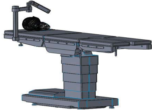
Şekil 3. PEK'in ameliyat masasına monte edilmiş hali
